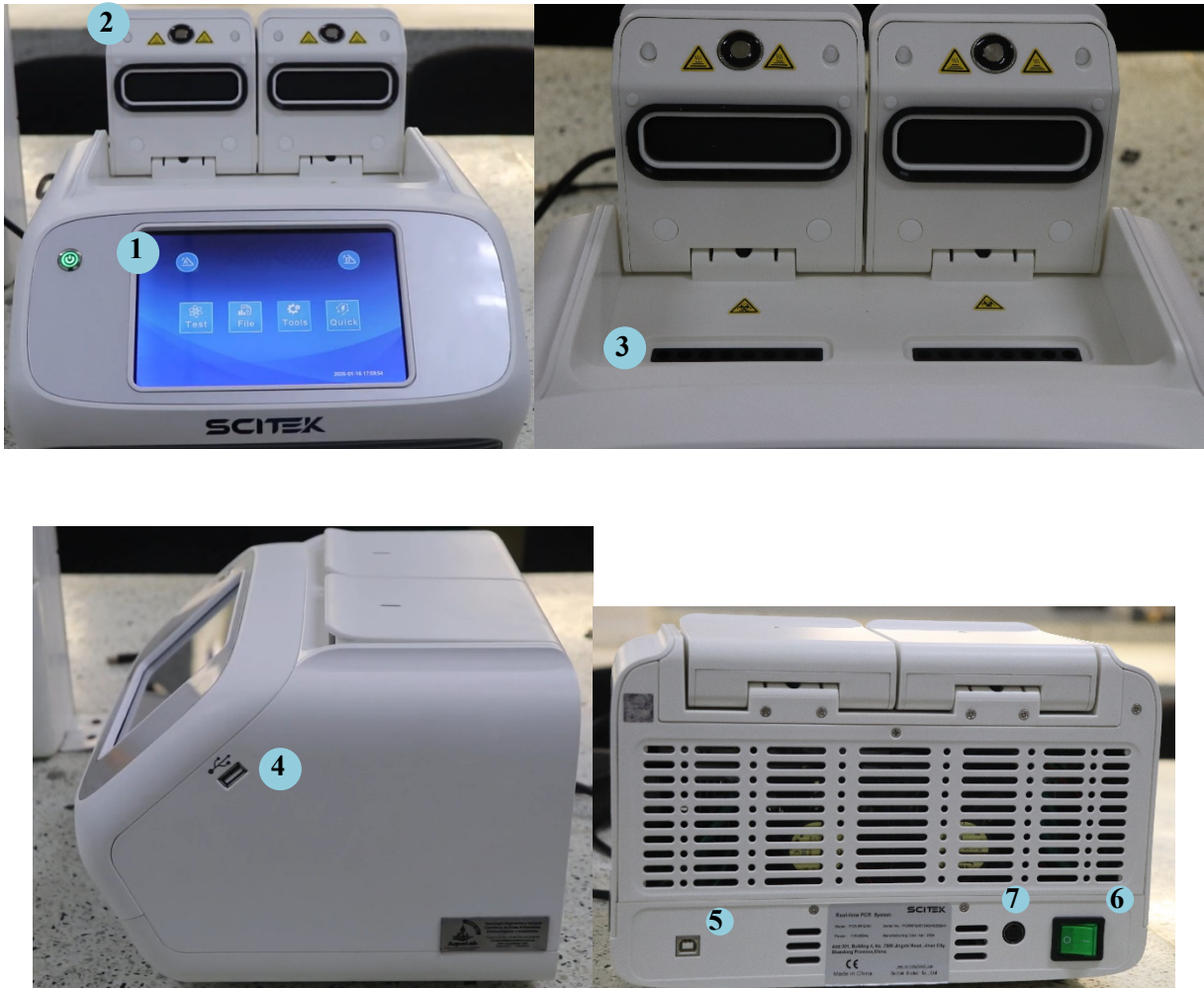
Figura 2. Componentes externos del termociclador. 1. Pantalla táctil. 2. Puerta del termociclador. 3. Bloque de reacción. 4. Puerto USB lateral. 5. Puerto USB zona posterior. 6. Botón prendido/apagado. 7. Toma de corriente.
