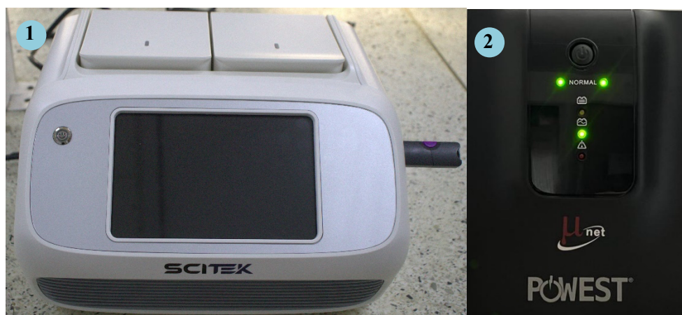
Figura 1. Equipo básico para el montaje de qPCR. 1. Termociclador Scitek software qPCR Linux integrado 2. Uninterruptible Power Supply – UPS (Powest, US 1000 ), fuente de alimentación ininterrumpida. }
