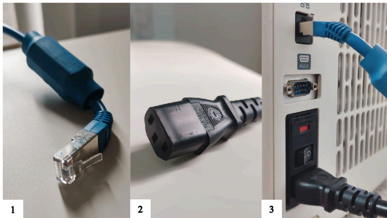
Figura 3. Conexiones. 1. Cable de red. 2. Cable de energía. 3. Posición de la conexión de los cables en el termociclador.
