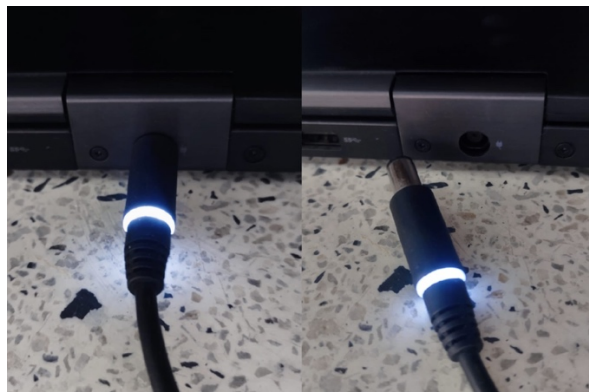
Figura 28. Proceso de desconexión del cable de energía del computador. Como se observa en la figura de la derecha el plug debe quedar desconectado del equipo.
